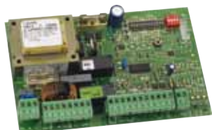
Řídící jednotka 452 MPS Technická specifikace viz. strana 134
