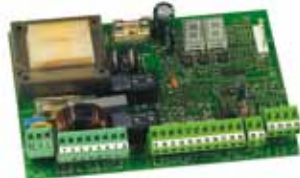
Řídicí jednotka 455 D Technická specifikace viz. strana 135
