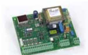
Řídící jednotka 578 D Technická specifikace viz. strana 139
